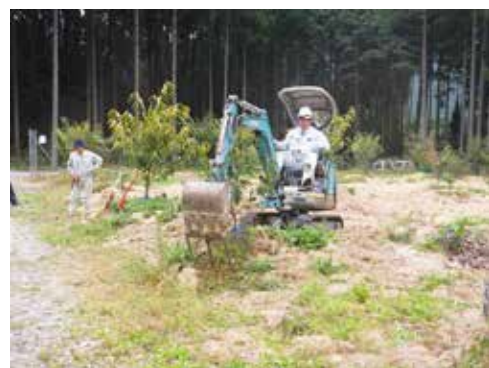
写真3 油圧ショベルによる株ゆるめ
